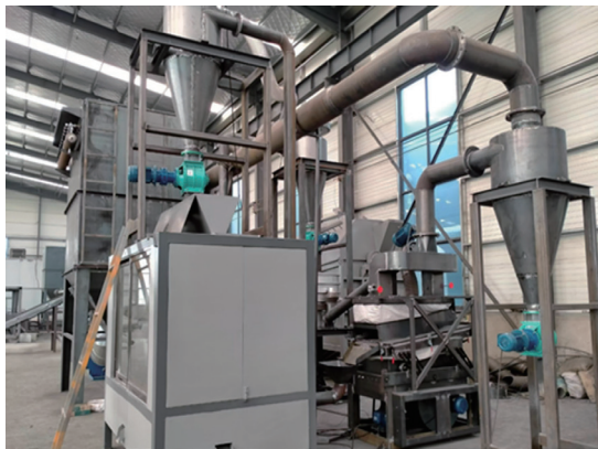
图 2 光伏板破碎分选回收设备
